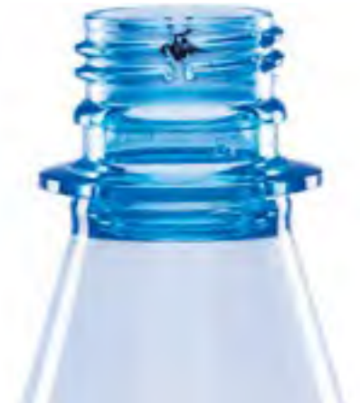
Dirty vent slot
